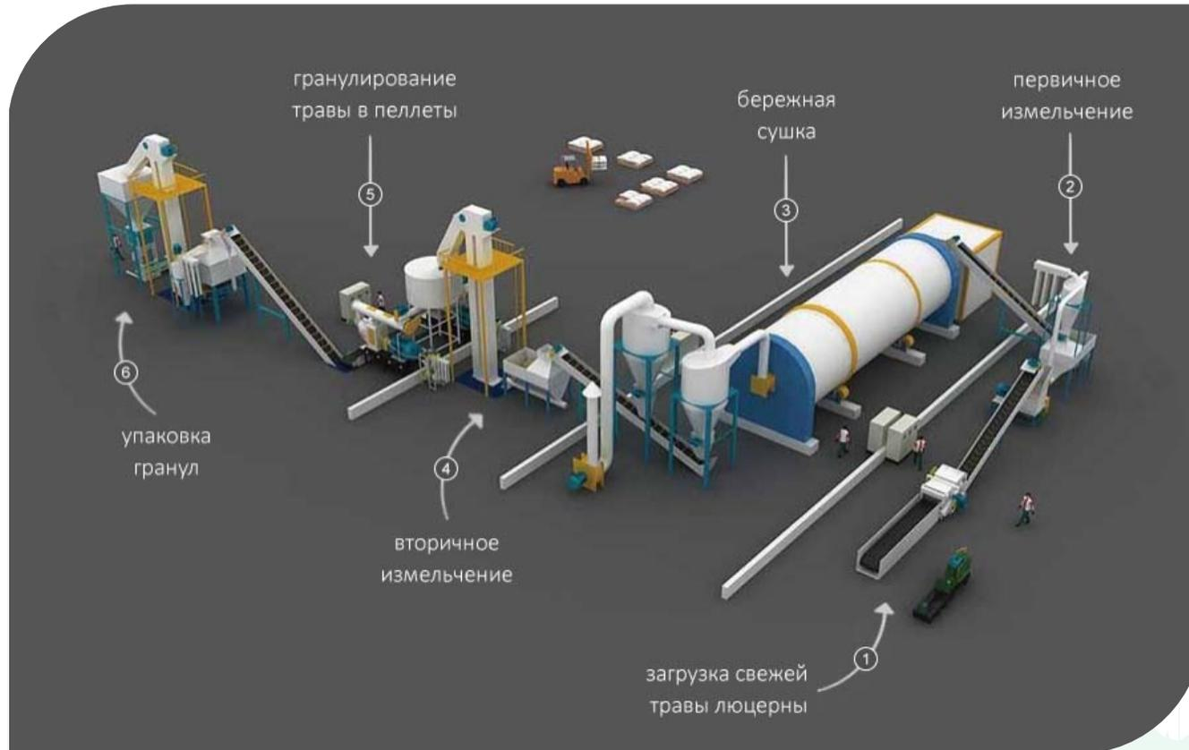
Процесс производства гранул с момента покоса до получения готовой гранулы занимает не более 10 часов и состоит из этапов:
